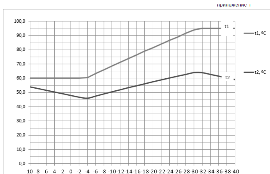
Рисунок 1 – Температурный график Сорской городской котельной
