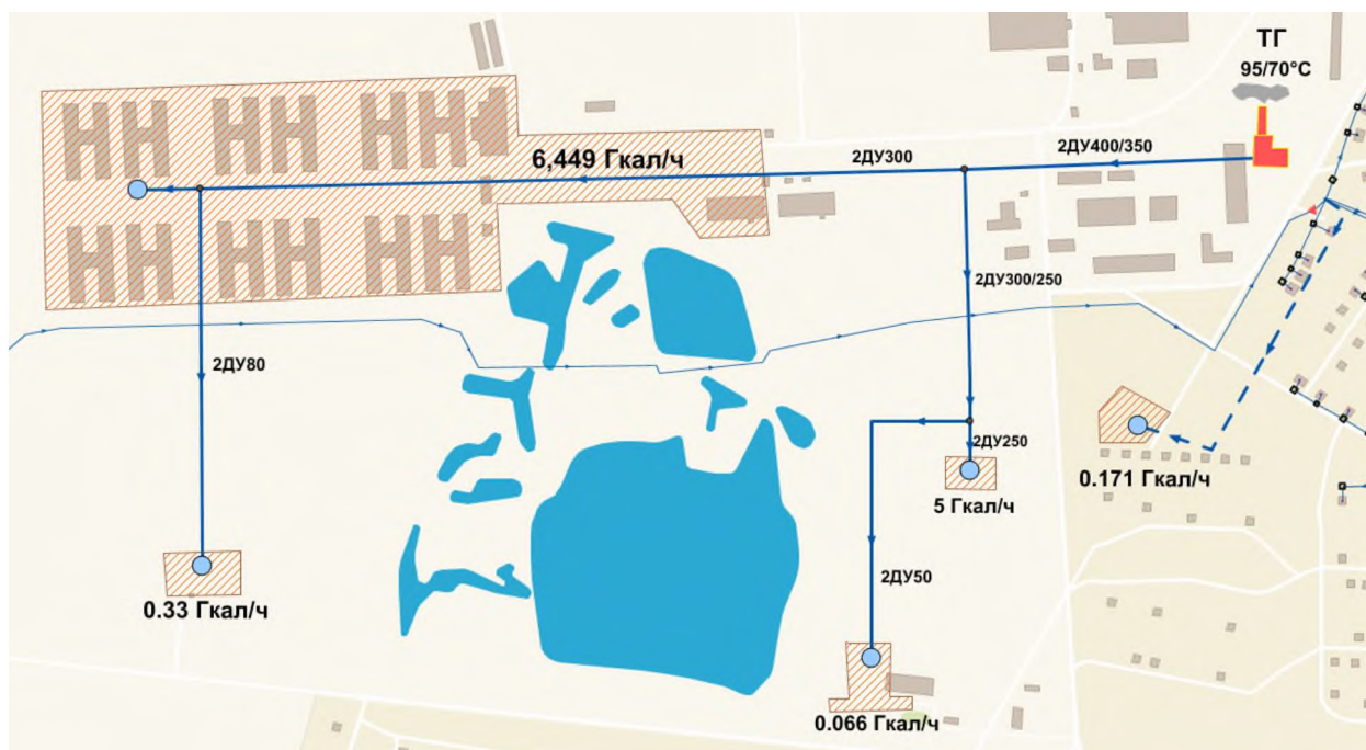
Рисунок 4.1 – Ориентировочная схема размещения котельной и т/сетей для подключения перспективных нагрузок потребителей
