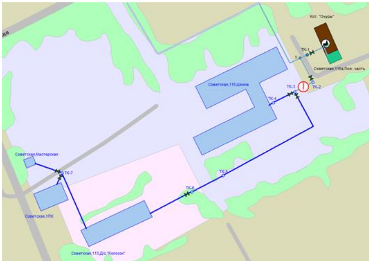
Рис. 8. Часть тепловой сети и потребители, отключенные от теплоснабжения.
