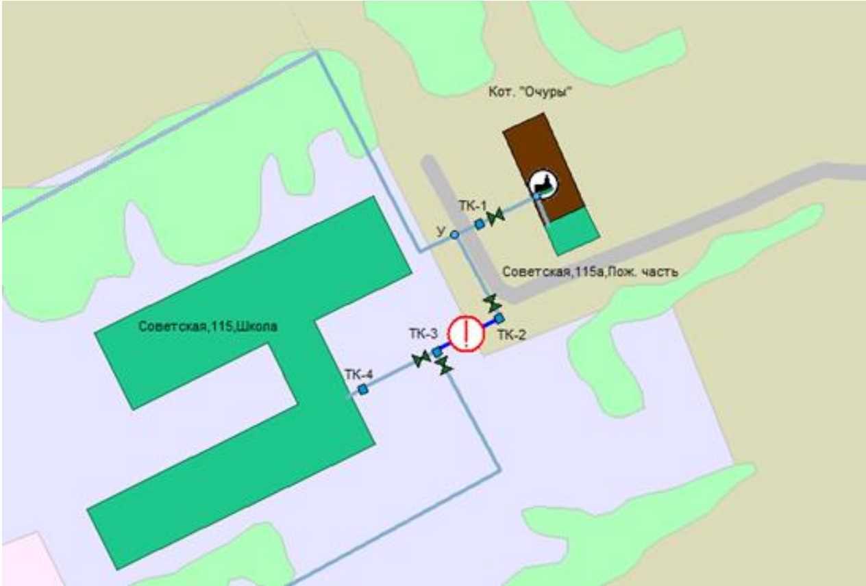
Рис. 9. Трубопроводы, перекрытые для проведения ремонтных работ.
