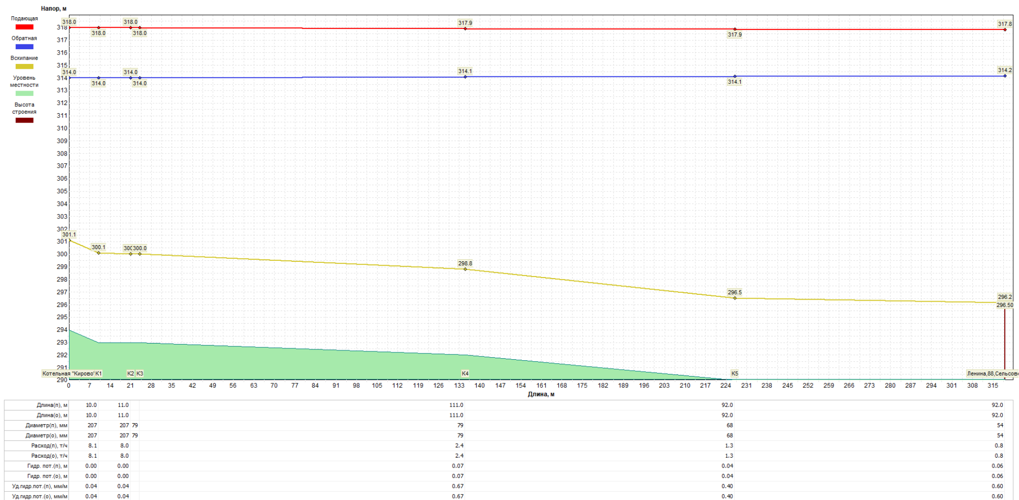
Рисунок 17. Пьезометрический график от Котельной до потребителя «Ленина,88, Сельсовет, Почта после снижения напорных характеристик источника.
