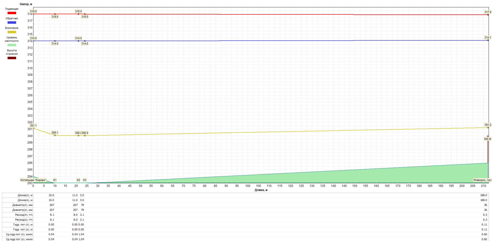
Рисунок 16. Пьезометрический график от Котельной до потребителя «Ленина,88, Сельсовет, Почта» после снижения напорных характеристик источника.
